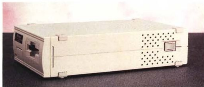
Il Nikon Super CoolScan è un apparecchio dalle dimensioni estremamente compatte. Sul retro le connessioni SCSI e la presa per l'alimentazione.
